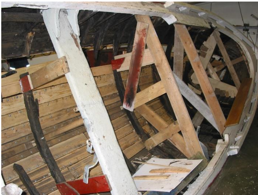
Gestur frá Vigur endursmíðaður 2004. Búið er að skipta um borð á neðri hluta bátsins. Mennirnir á efri myndinni eru bræðurnir Guðfinnur og Ragnar Jakobssynir í Bolungarvík. Ljós.: Byggðasafn Vestfjarða.
